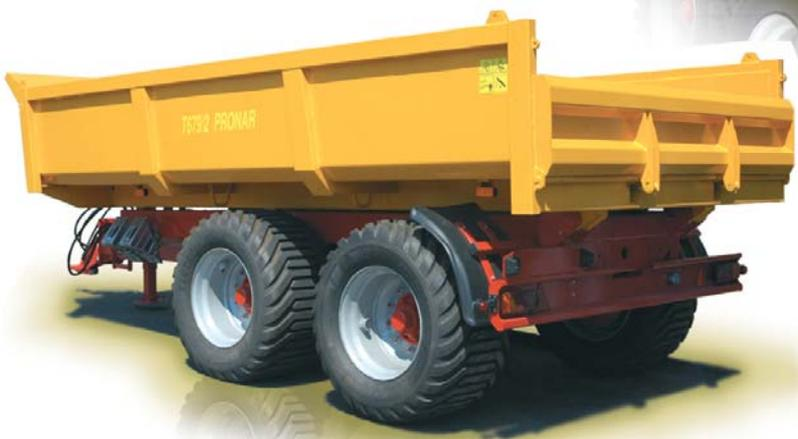
работ, требующих разгрузки большого количества материала на ограниченной площади. В дополнение к богатому стандартному оснащению предусмотрена широкая гамма опций: надстройки для PRONAR T679/2, конструкция из износостойкой стали Hardox или ссыпной клапан, который открывается с помощью
