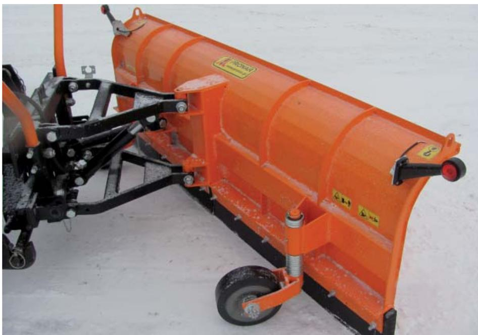
Очистка от снега площадки с твердым покрытием с помощью снегоотвала PRONAR PU-2200E
