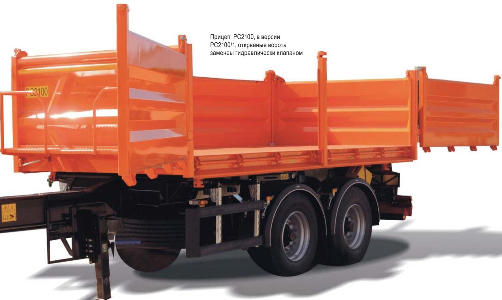
Прицеп PC2100, в версии PC2100/1, открываемые ворота заменены гидравлически клапаном
