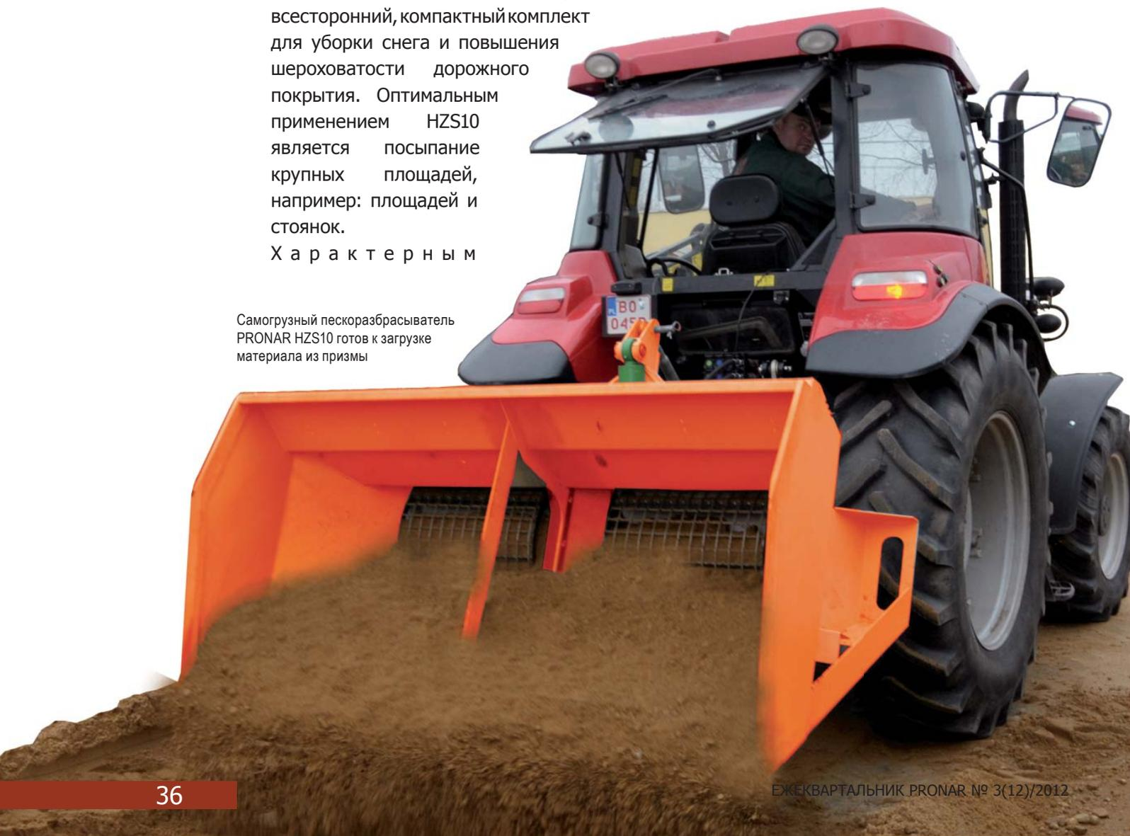
Сцепка с трактором: самогрузный пескоразбрасыватель HZS10 и снегоотвал PRONAR PUV-2800 образуют универсальный комплект машин, которые обслуживаются только водителем трактора
