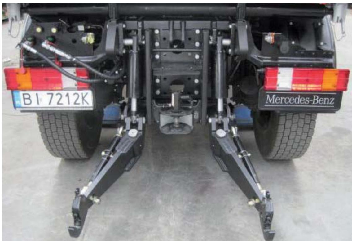
Задняя СТН с автоматическим транспортным крюком, установленном на носителе (Unimog U400)
