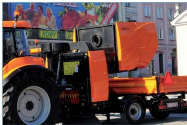
Опорожнение бункера подметально-уборочной машины ZMC 2.0
