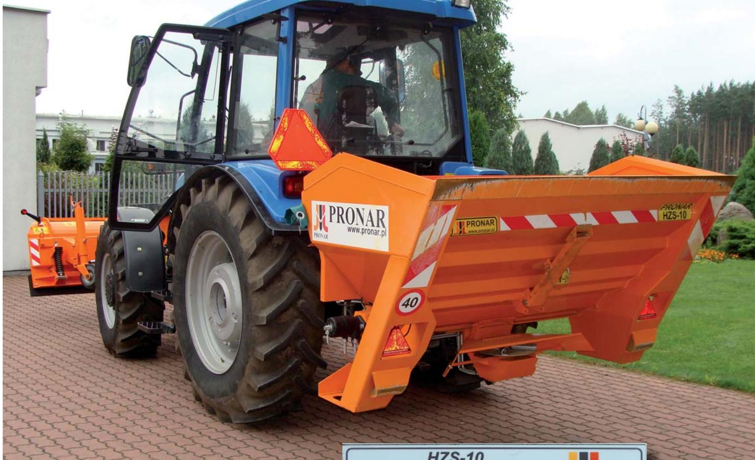
1000 литров. Нажатие кнопки на панели управления переключает машину из режима загрузки в режим разбрасывания, благодаря чему машина готова к работе с последними введенными параметрами разбрасывания. Стабильность параметров контролируется двумя датчиками оборотов, расположенными на гидродвигателях. Первый с помощью шнекового конвейера производит дозировку материала: песка, соли или смеси, а второй разбрасывает его с помощью диска с лопатками на необходимую ширину.
