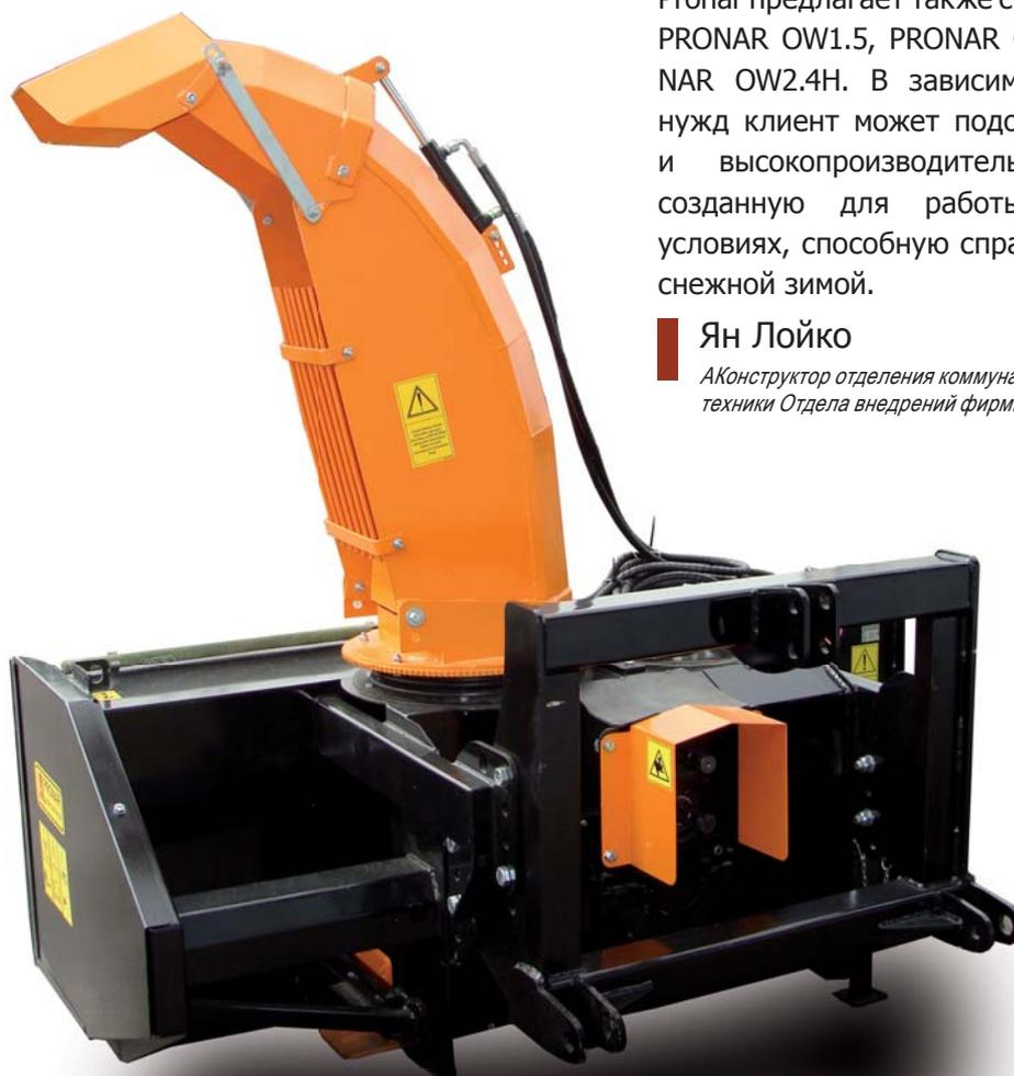
Рама для крепления к системе трехточечной навески инструментов в соответствии с ISO 730-1 II и III категории. Система позволяет с легкостью переоборудовать сцепное устройство в соответствии с требованиями пользователя
