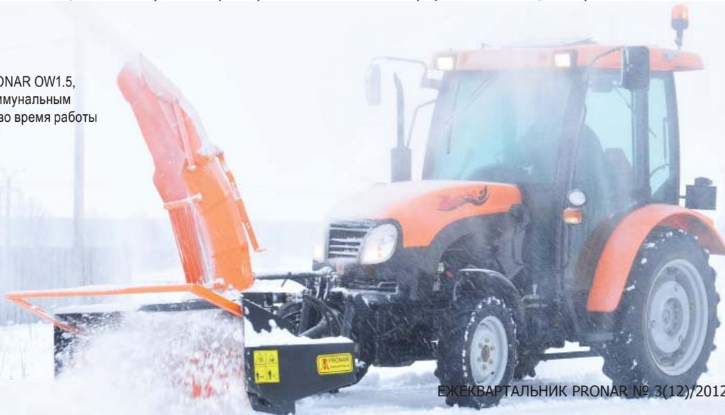
там ротор выбрасывает их с большой скоростью в трубу. Эти элементы установлены в легкой, но при этом прочной конструкции, обеспечивающей прочность и высокую производительность в течение долгого срока эксплуатации. Применение износостойкой стали для производства скользунов и лемехов обеспечивает долгий срок службы этих элементов.
