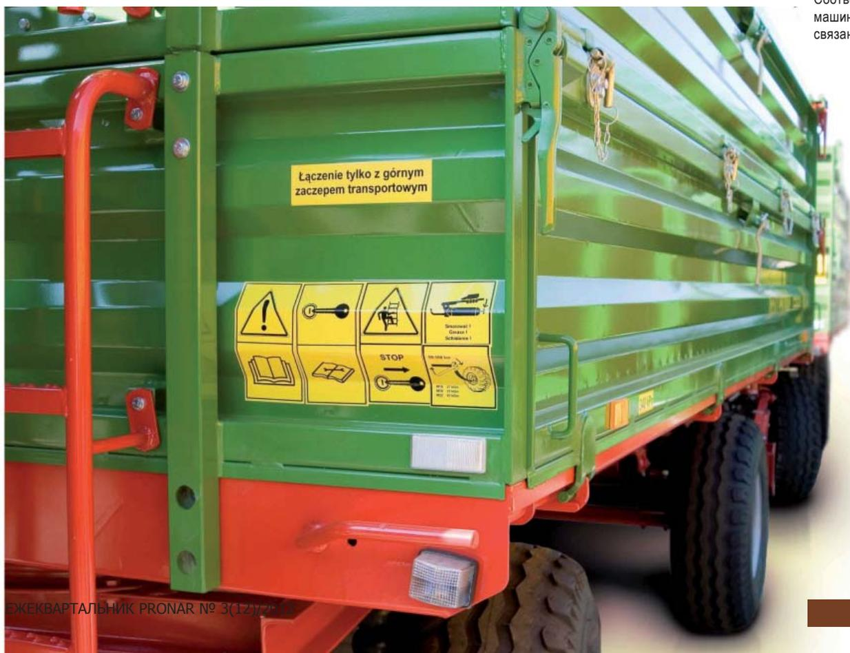
Соответствующая маркировка на машине снижает степень опасности, связанной с ее использованием
