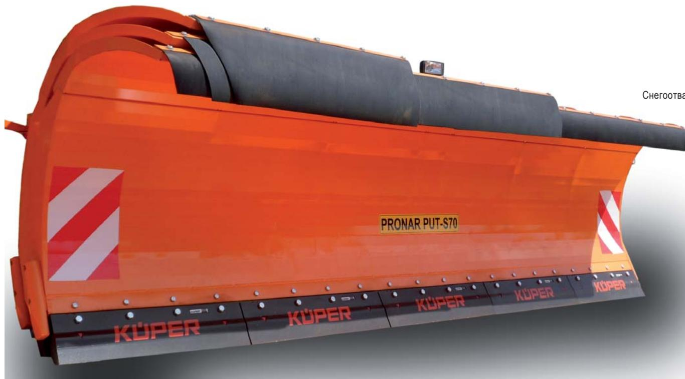
Для сцепления снегоотвала с носителем последний был оборудован вращающейся монтажной плитой, изготовленной согласно стандарту DIN 76060, тип А. Ее вращающееся крепление позволяет копировать поверхность почвы в пределах  $\pm 10^\circ$ . Носитель инструментов должен иметь как минимум три гидравлические секции для привода выдвижения отвалов, их поворотов и подъема снегоотвала, а также электрический разъем для габаритного и рабочего освещения. Большой вес
