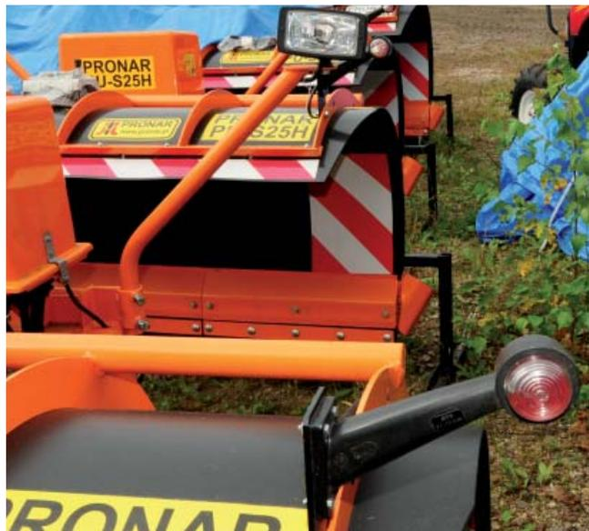
Снегоотвал PU-S25H - габаритные огни лемеха
