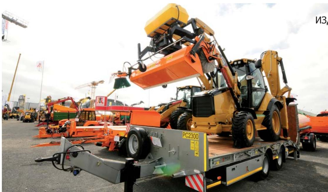
Система навески подметально-уборочной машины ZM 2000 позволяет агрегировать ее с экскаватором-погрузчиком CAT 432E
